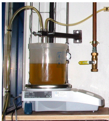
FIG. 2.5 – Système de mesure du débit de gasoil.
