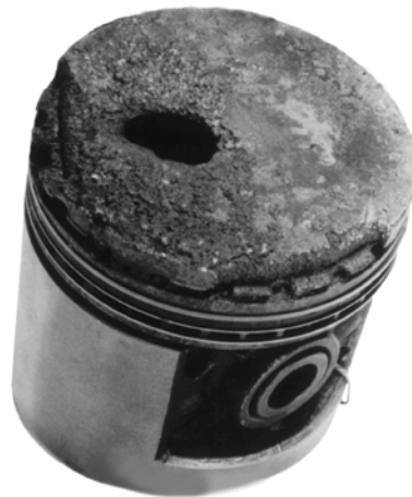
FIG. 4.17 – Dommages provoqués par le cliquetis sur un piston.
